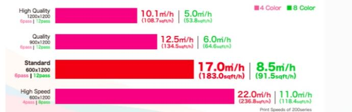
a Mimaki CJV200 es una impresora/plotter de impresión y corte que alcanza velocidades de hasta 17 m<sup>2</sup>/h en modos de alta calidad o hasta 56.2 m<sup>2</sup>/h en modos más rápidos. Además de su velocidad de impresión, también tiene una velocidad de corte máxima de 300 mm/s.
